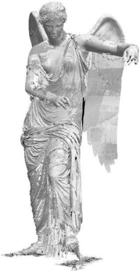
Figura 3: Nuvola di punti completa della statua (480 viste).
